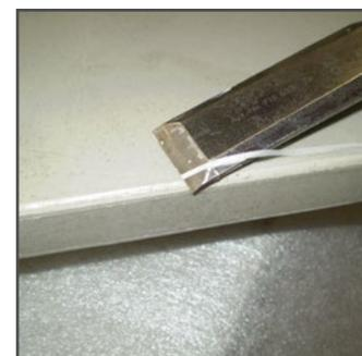
6. Oberfläche und Fasse mit einem stumpfen Schleifpapier Körnung 320 leicht bündig schleifen.
