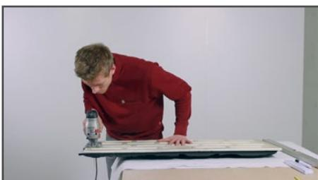
Sägen Sie, z. B. mit einer Handkreissäge mit Führungsschiene, langsam entlang der Markierung.
