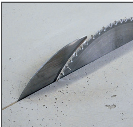
Bearbeitung mit normalen HM-Werkzeugen
